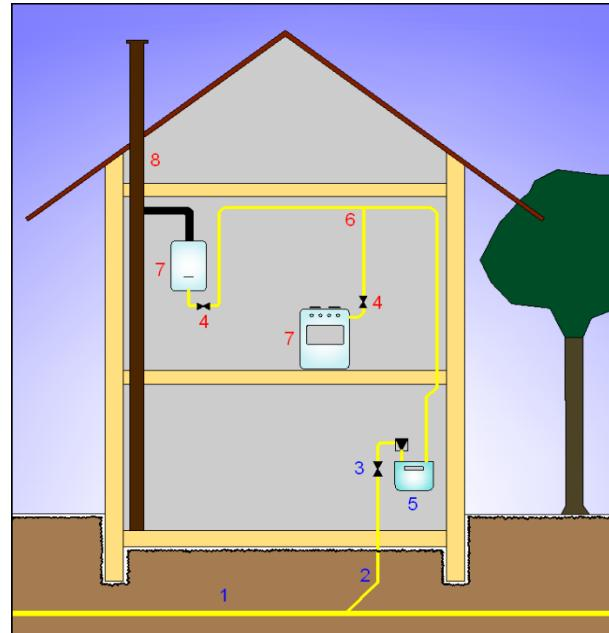
Plinski aparati (7) trebaju zrak za izgaranje, a posebno oni koji ga uzimaju iz prostorije u kojoj su postavljeni. Samo plinski aparati neovisni o zraku u prostoriji dobivaju zrak za izgaranje direktno izvana. Pitajte svog servisera koju vrstu aparata imate.
